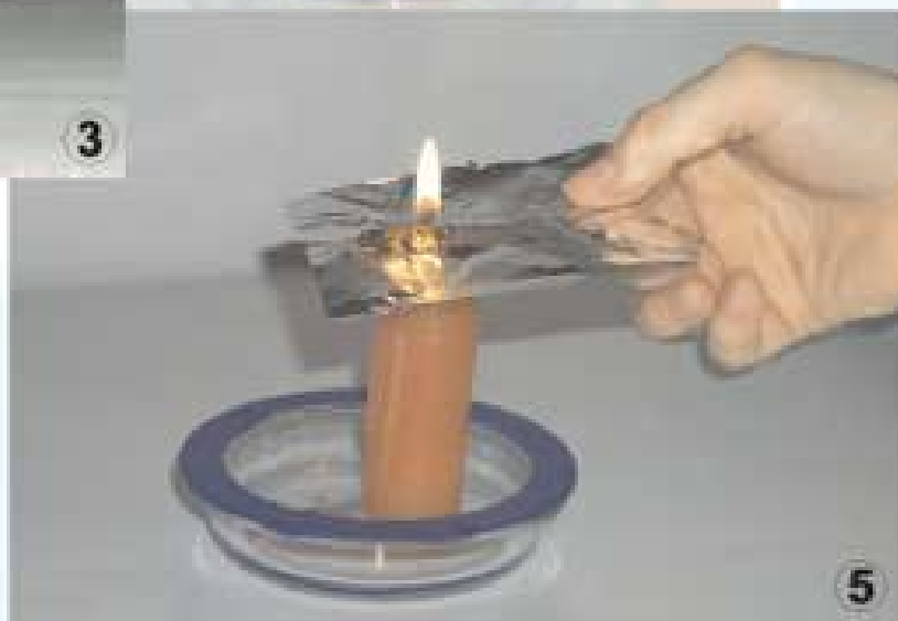
Исследование пламени с помощью алюминиевой фольги
